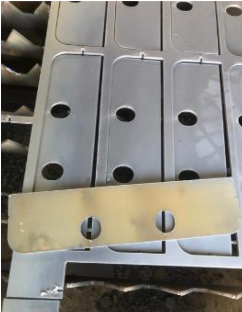
Şekil 6. 4 mm kalınlığındaki St37 malzemenin kesim işlemi
