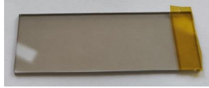
Şekil 5. 25.4×76.2 mm boyutlarında cam alttaş üzerine 50 nm kalınlığında reaktif NiO biriktirme.
