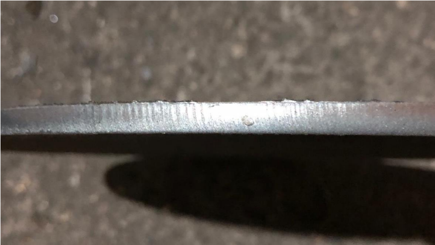
Şekil 8. 6 mm kalınlığındaki St37 malzemenin kesim işlemi
