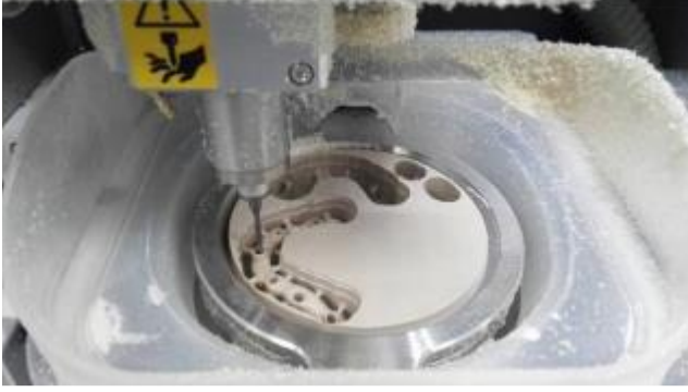
Şekil 3. CAD/CAM ile PEEK üretimi (Tipton, 2015)
