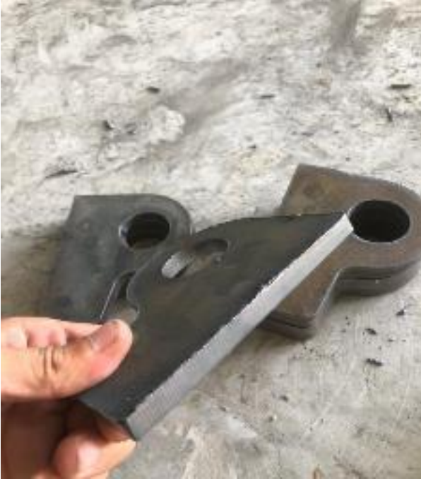
Şekil 10. 10 mm kalınlığındaki St37 malzemenin kesim işlemi
