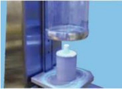
Şekil 4. Enjeksiyon kalıplama yöntemiyle PEEK üretimi (Türkkal)
