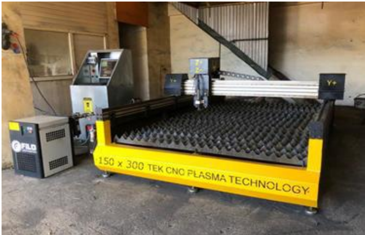
Şekil 2. St37 malzemesinin kesim işleminde kullanılan CNC plazma tezgâhı
