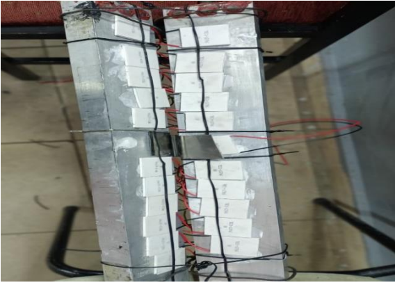
Şekil 2.3 TEM'lerin Soğutma Bloğundaki Yerleşimi
