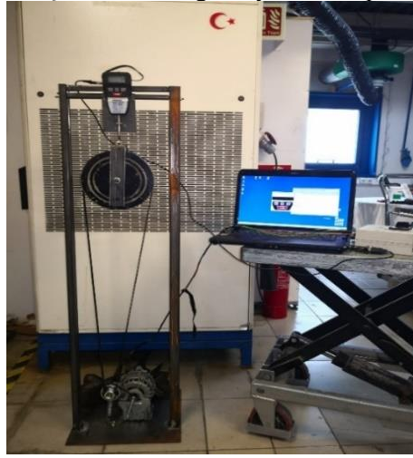
Şekil 11. Dengesiz yüklü setup
